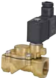
2-Wege Magnetventil zur Wassernachspeisung in Sammelbehältern oder sonstige Anwendungen. Bauweise: stromlos geschlossen, 230 V, vorgesteuerte Membran 0,35 - 9 bar, Schutzart IP 65.
