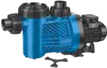
BADU® Resort Blockpumpe mit integriertem Fasernfänger (ca. 10 l) für hohe Umwälzleistungen in größeren Filteranlagen, aufstellbar oberhalb o. unterhalb des Wasserniveaus bis jeweils max. 3 m. Anschlüsse mit Überwurfverschraubung/Klebemuffe
