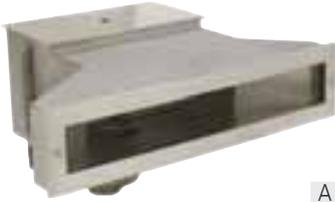
Extra schmale Saugöffnung für möglichst hohes Wasserniveau im Becken. Saugbreite 500 mm und Höhe der Saugöffnung 85 mm; Skimmerklappe aus Edelstahl; Sauganschluss 2" IG, Überlauf mit Klebemuffe d 50 mm nach unten.
