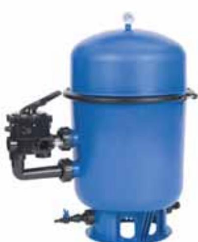
Hochwertiger Filterbehälter aus glasfaserverstärktem Polypropylen für einen Betriebsdruck bis 2 bar (Prüfdruck 2,5 bar).
