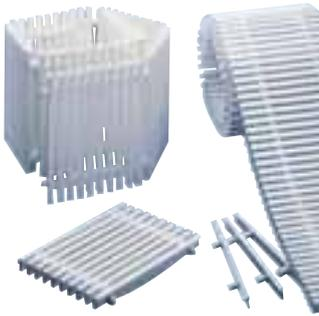
**Rinnenrostplatte** aus Polypropylen, verrottungsfest, weiß, sehr stabil und mit rutschhemmender Oberfläche. Die Platten werden bauseitig mit einem Clip-System zusammengefügt (5 Stück = 0,975 m)
