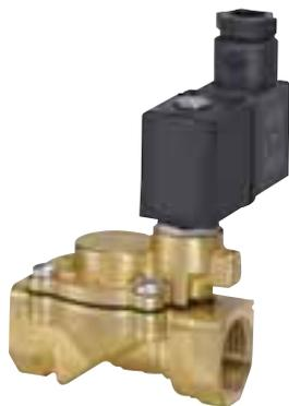
2-Wege Magnetventil zur Wassernachspeisung in Sammlerbehältern oder sonstige Anwendungen. Bauweise: stromlos geschlossen, 230 V, vorgesteuerte Membran 0,35 - 9 bar, Schutzart IP 65.
