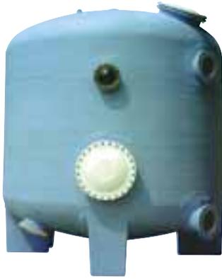
**Filterbehälter** zur Wasseraufbereitung nach DIN 19605\*/19643 aus **glasfaserverstärktem (radial und polar gewickelt) Polyesterharz** mit Chemischschicht nach DIN 18220 aus Gel-Coat-Vinylester **mit KSW-KTW-Prüfung** nach DVGW Arbeitsblatt W 270. **Alle Behälteranbauten** (Roh- + Reinwasseranschlussflansche, Entleerung, Entlüftung, Schauglas, Standfüße) werden **werkseitig anlaminiert** – dadurch keine separate Abdichtung an Behälterdurchdringungen erforderlich!
