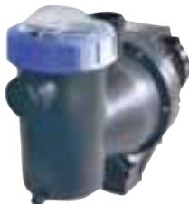
Selbstansaugende Filterpumpe mit robustem Pumpengehäuse aus glasfaserverstärktem Polypropylen und einem großen 4 l-Vorfilter, Anschlussverschraubung Saug- und Druckseite mit Klebemuffe d 50, Steckerfertig mit 2,8 m Anschlusskabel
