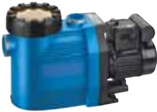
Korrosionsbeständige Pumpe mit wasserführenden Teilen aus gf-verstärktem Polypropylen. Zuverlässige Abdichtung durch wartungsfreie, geschlossene Balg-Gleitringdichtung, montiert auf Kunststoff-Laufradnabe. Unempfindlich gegenüber im Schwimmbadwasser üblichen Verunreinigungen (wie Blätter u. ä.) durch integrierten Fasernfänger mit herausnehmbarem Saugsieb.
