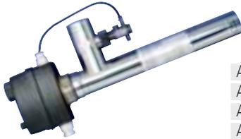
Elektropoliertes Gehäuse, Heizstab Incoloy 825, mit einpoligem Regelthermostat 0 - 40 °C, einpoligem Sicherheitsthermostat 55 °C + Strömungswächter sowie Kunststoff-Wandhalterung. Betriebsdruck max. 3 bar, Anschlüsse 1½" x NW 50
