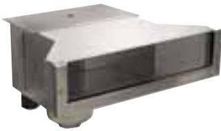
Komplett mit Flanschsatz und Blende für Folienbecken. Saugbreite 500 mm, f. Wasserniveau bis 4 cm unter Beckenrandstein Sauganschluss 2" IG, mit Edelstahl Siebkorb, Überlauf d 50, mit **Beruhigungskammer** für elektronischen Wasserstandsregler Deckel aus gebürstetem Edelstahl, Durchfluss max. 7,5 m³/h
